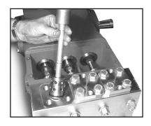
4) Take out valve assemblies (52 & 51) using either tool (part #07662) or a stud bolt.
